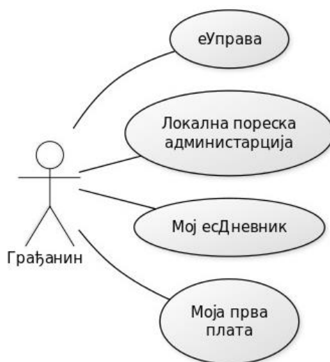
Слика 2.9. Дијаграм случаја коришћења апликације ConsentID за пријаву на тренутним порталима
