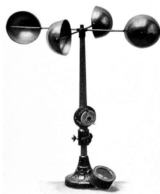
Слика 3. Анемометри са ротирајућим чашама 3
