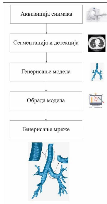
Слика 22. Фазе процеса реконструкције
