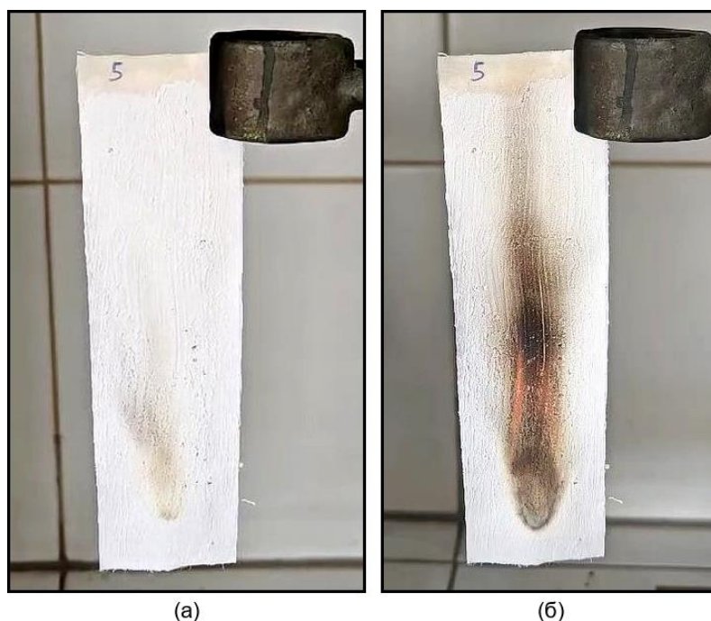
Слика 4.30. Промене на површини модификоване памучне тканине узорка при излагању отвореном пламену: а) након 23 s; б) након 95 s
