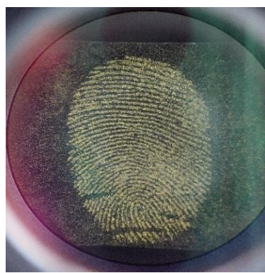
Слика С4. Масни отисци палца десне руке на стакленој површини развијени применом прашкастих конјугата: 1) У9 и 2) У8, снимљени непосредно након визуализације: а) без позадинског осветљења, б) уз контрастну технику светлог поља и в) уз контрастну технику тамног поља, помоћу оптичког микроскопа (увећање \times 7,5 ).
