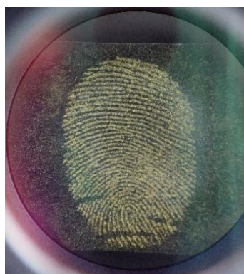
Слика С4. Масни отисци палца десне руке на стакленој површини развијени применом прашкастих конјугата: 1) У9 и 2) У8, снимљени непосредно након визуализације: а) без позадинског осветљења, б) уз контрастну технику светлог поља и в) уз контрастну технику тамног поља, помоћу оптичког микроскопа (увећање \times 7,5 ).
