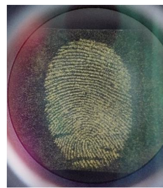
Слика С4. Масни отисци палца десне руке на стакленој површини развијени применом прашкастих конјугата: 1) У9 и 2) У8, снимљени непосредно након визуализације: а) без позадинског осветљења, б) уз контрастну технику светлог поља и в) уз контрастну технику тамног поља, помоћу оптичког микроскопа (увећање \times 7,5 ).
