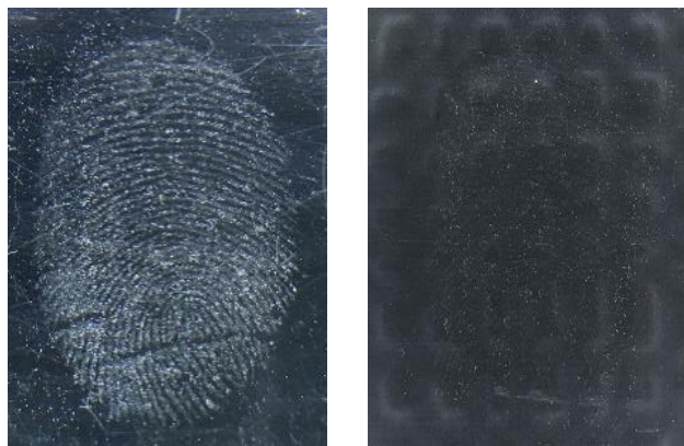
Слика 26. Масни отисци палца десне руке једног донора мушког пола, развијени на а) стакленој и б) гуменој површини, помоћу формулације У14, који су потом фотографисани под видљивим светлом са црном позадином у циљу добијања одговарајућег контраста.
