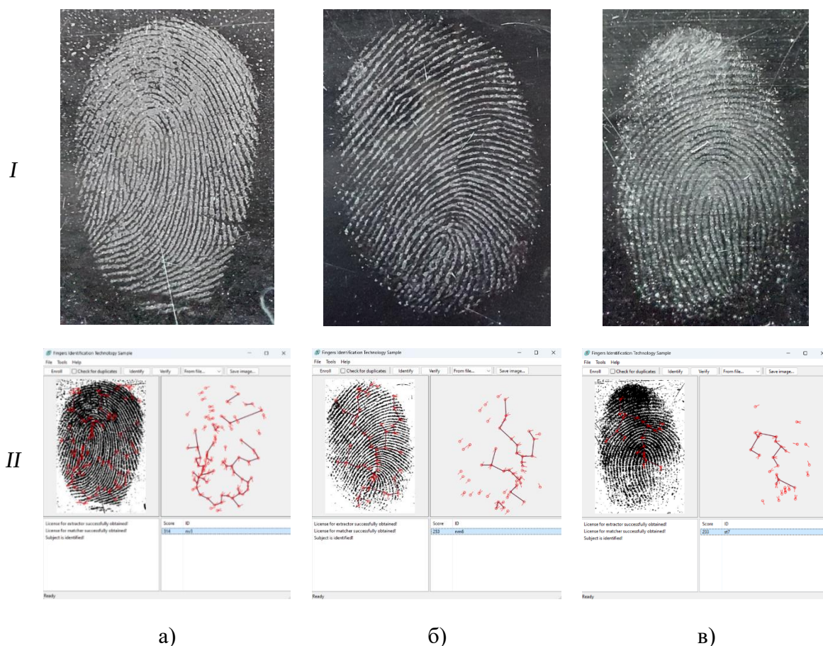
Слика 35. Масни отисци прстију троје донара, и то отисак средњег прста десне руке једног донара мушког пола (а)), палца леве руке другог донара мушког пола (б)) и кажипрста леве руке донара женског пола (в)), депоновани на стаклену микроскопску плочицу и визуализовани помоћу формулације У7 (I), који су потом фотографисани, софтверски обрађени и отпремљени у аутоматски систем за идентификацију отисака прстију (II) (за троје донара а), б) и в), редом). Приликом поступка верификације добијени су исти резултати као приликом идентификације донара.
